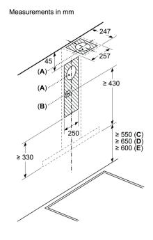
**A:** Exhaust air outlet **B:** Socket
